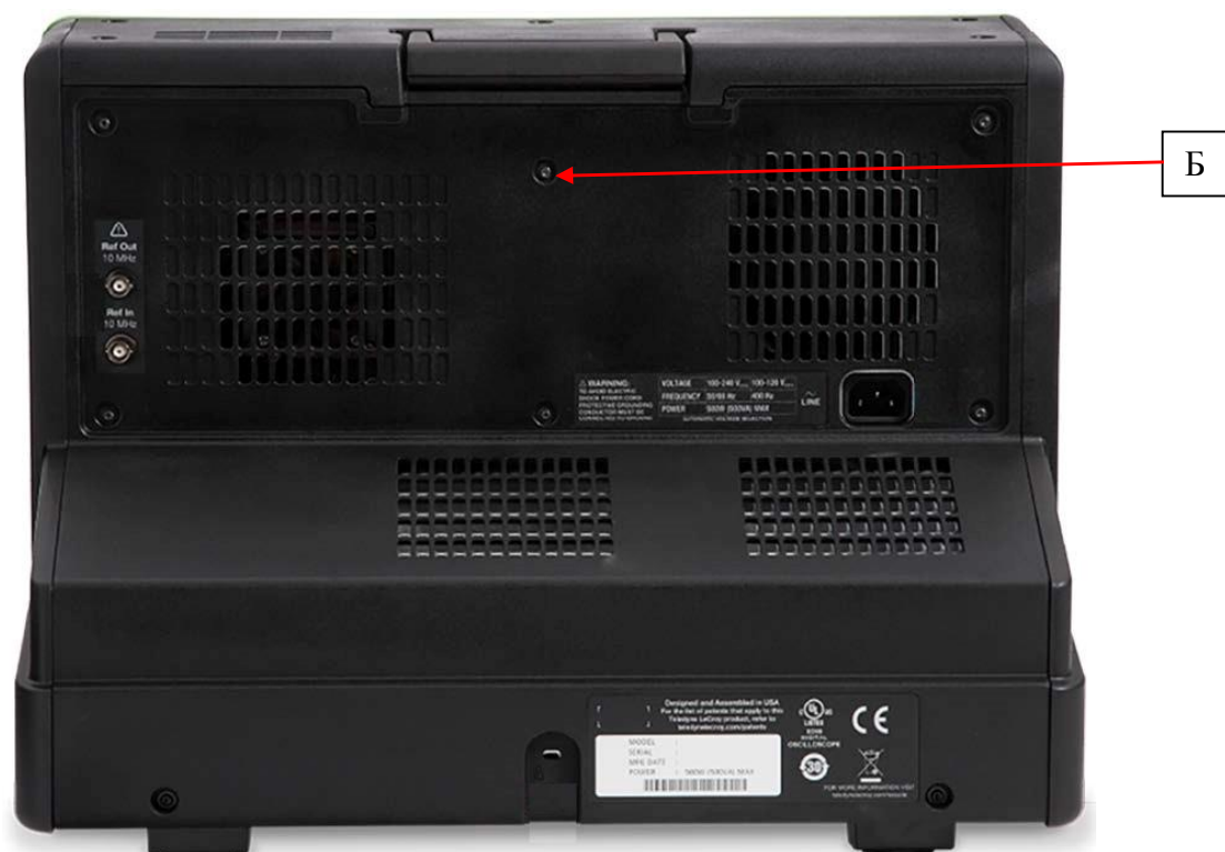
Рисунок 2 – Схема пломбировки от несанкционированного доступа (Б)
